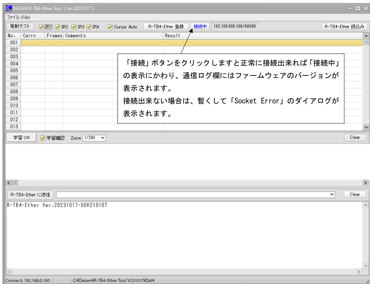
画面下の通信ログ表示欄に R-TB4-Ether のファームウェアのバージョンが表示されます。
