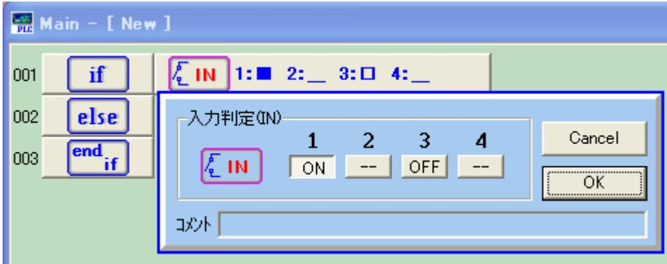
IN 1 ~ IN 4 の入力状態を判定して条件分岐します。
