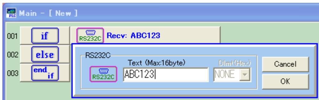
R S 2 3 2 C の電文を判定して条件分岐します。
