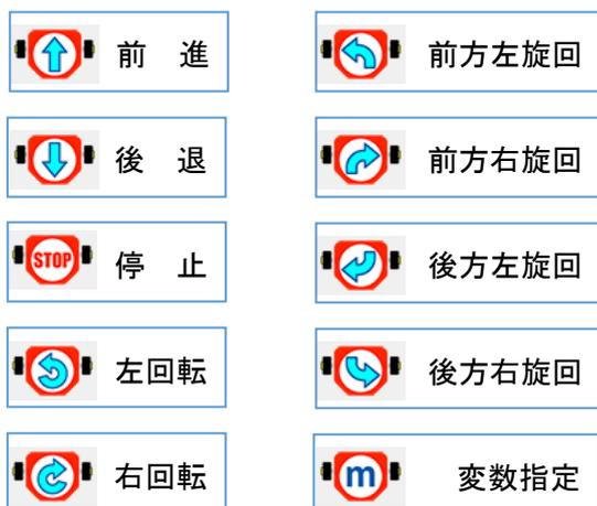
左右の速度が同一方向で 20%以上の場合はモーターアイコンが旋回アイコンの表示となります。
