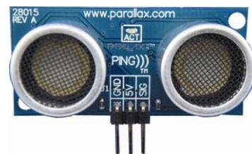
CN7 と CN8 に超音波距離センサーを接続して、左右の壁の間を通り抜けるプログラム例
