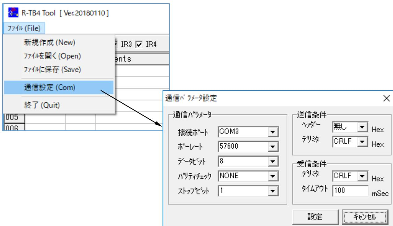
**通信ポート** : COM1からCOM8 (USBドライバーが設定したCOMポートに合わせる)
