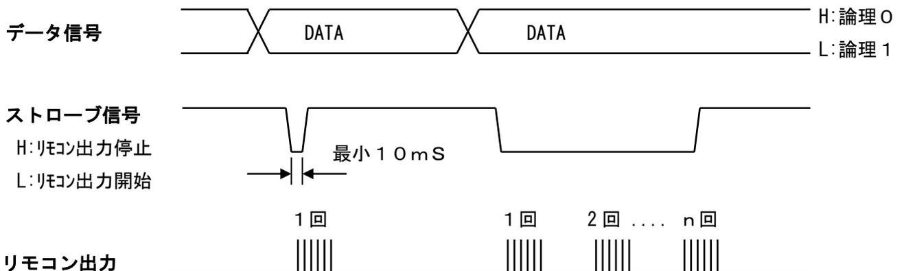
※出力先指定信号は、ストローブ信号が出力される以前に4本の内最低1本はアクティブ(Low)にして下さい。
