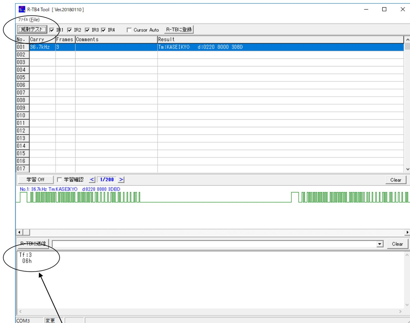
該当する学習テーブル表の行にカーソルを移動し、「発射テスト」ボタンをクリックすると、通信ログ表示欄にリモコンコードの発射フレーム数（T f : 3）が表示され、その後R-TB4から発射完了通知（ACK : 06h）が表示されます。
